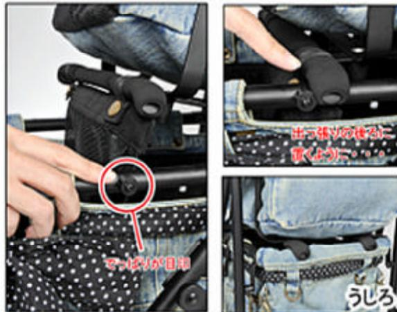
下段のフレームについているでっぱり部分を目印にして上段フレームがでっぱりのすぐ後ろにくるようにします。
